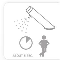
5. Patiencez environ 5 secondes afin de permettre au système de régler la portée idéale du capteur. Une fois l'auto réglage accompli, l'électrovanne s'ouvrira et se refermera au bout d'une seconde. A titre d'indication, vous verrez une petite quantité d'eau sortir du bec verseur. Le produit sera alors prêt à l'utilisation.
