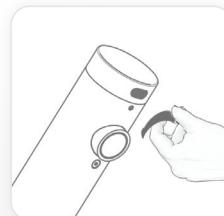
Ensuite, retirez l'autocollant de protection qui couvre le capteur.
